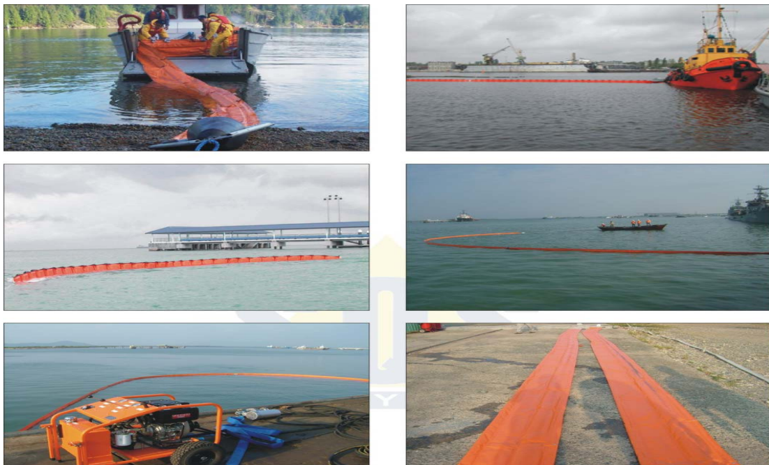
Hình 11. Phao quay dầu tự nổi dạng dẹp.
