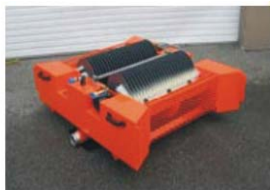
Hình 13. Máy hút dầu loại Disk.
