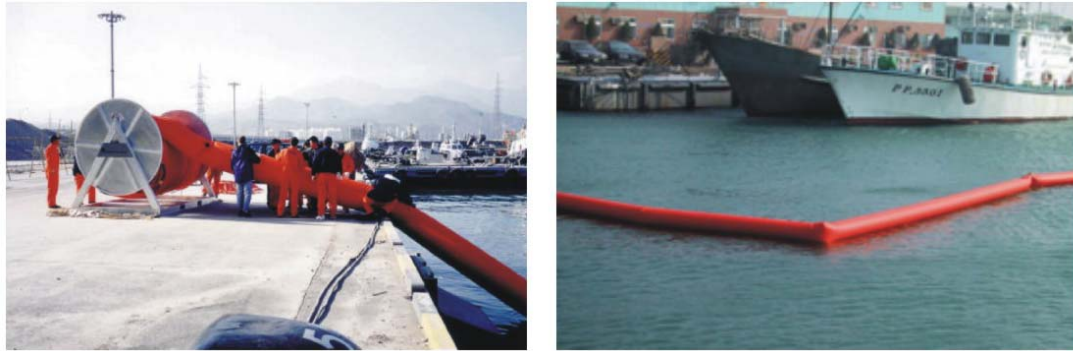
Hình 8. Phao quay dầu bơm khí.
